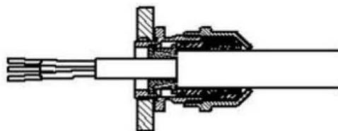
Die Einzelteile zusammen mit dem Kabel in den montierten Stutzen führen. Hutmutter mit dem Drehmoment der der jeweiligen Größe anziehen.
