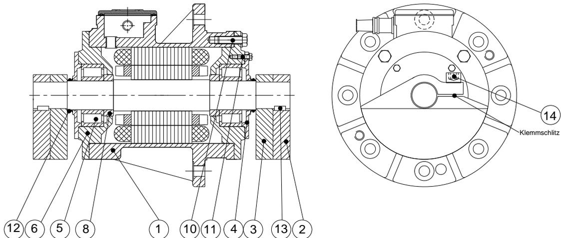
1. Stellung der verdrehbaren inneren Fliehscheiben (3) markieren oder notieren. Befestigungsschrauben (14) der Fliehscheiben lösen.
