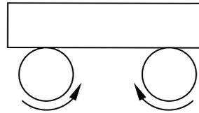
2 Motoren gegenläufig = Lineare Schwingung
