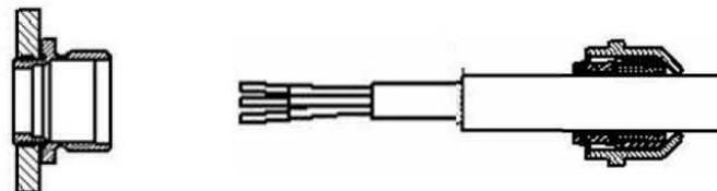
Kabelaussenmantel abisolieren, Hutmutter und Klemmkäfig mit der Dichtung auf das Kabel schieben.
