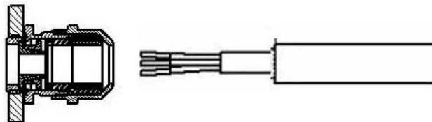
Kabelverschraubung montieren. Stutzen fest anziehen
